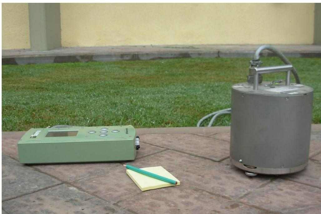
**Figura 5:** A la derecha, sismómetro de banda ancha (BB) modelo 40-T (Güralp). A la izquierda, sistema digital de adquisición de datos TAURUS (Nanometrics Inc.) de 24 bits.
