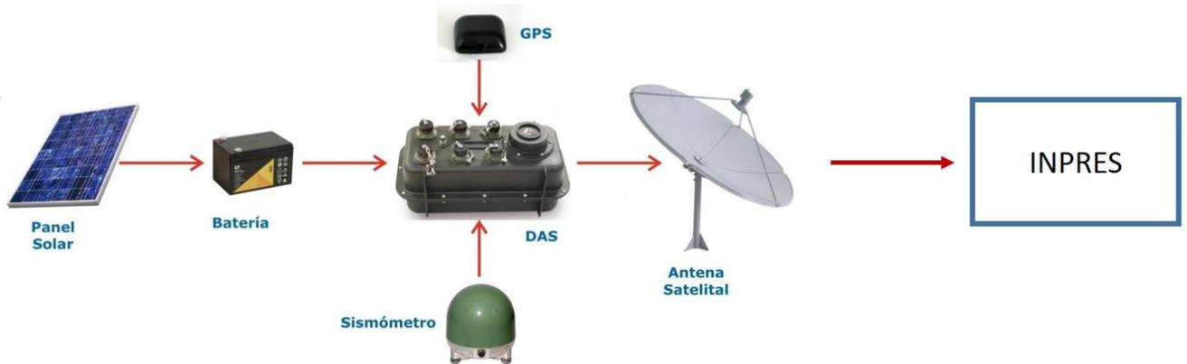
**Figura 3:** Estación sismológica digital tipo enviando datos en tiempo real a la sede de INPRES para su posterior procesamiento.
