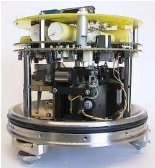
**Figura 4:** Sismómetro de banda ancha (BB), modelo 40-T (Güralp), de tres componentes ortogonales, con respuesta plana en el rango frecuencial de 33,3mHz (30 seg) a 50 Hz. Sin cubierta.
